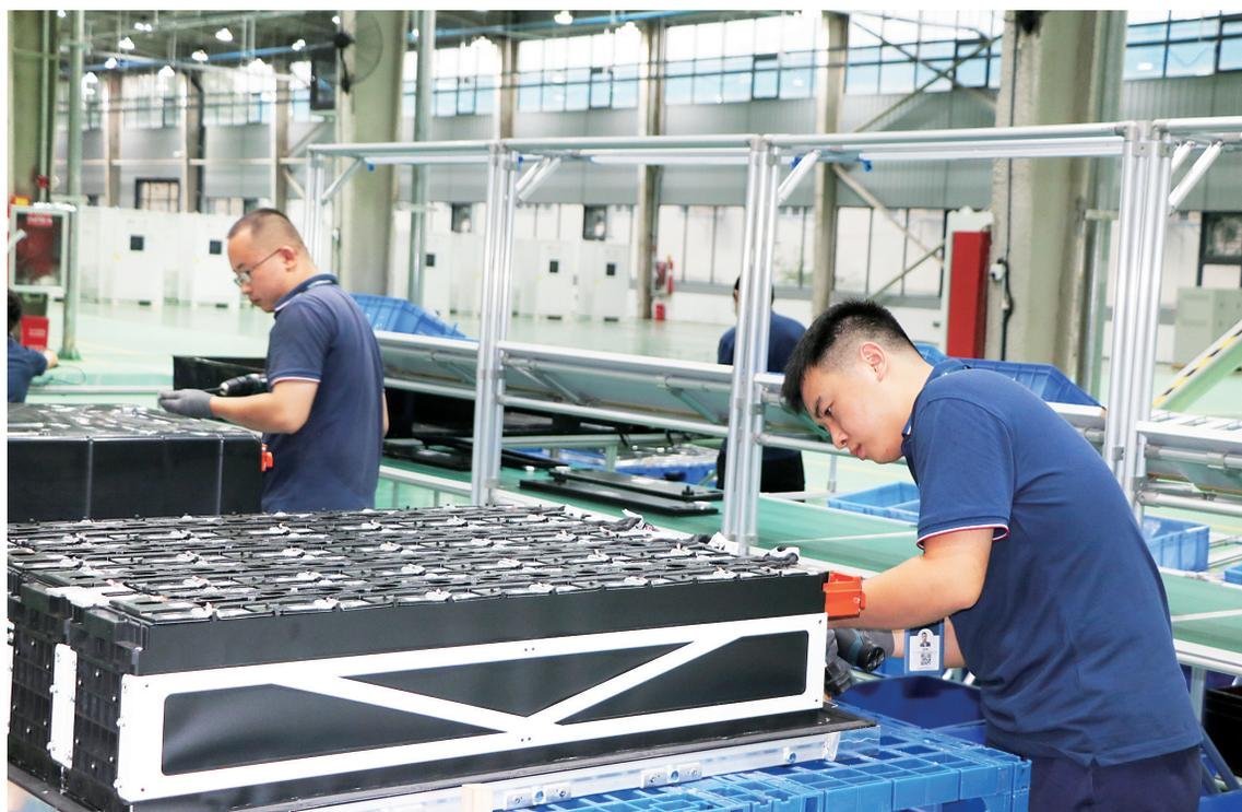
昨日,位于潢川县工业大道的河南科创储能科技有限公司内,工人正忙着封装储能电池。该公司专注于电化学储能技术创新,集科研、制造、营销、服务为一体,产品主要应用于集中共享式储能、构网型新型能源电力系统、风光储充一体化等领域。
