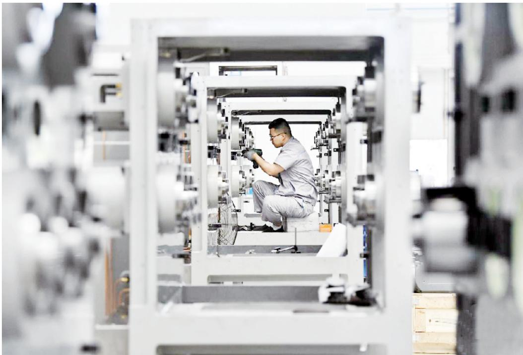
8月19日,位于玉田县的唐山晶玉科技股份有限公司工人在组装高精密度线切割机。
