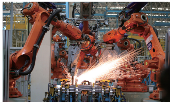
海马汽车工厂高科技智能焊装
