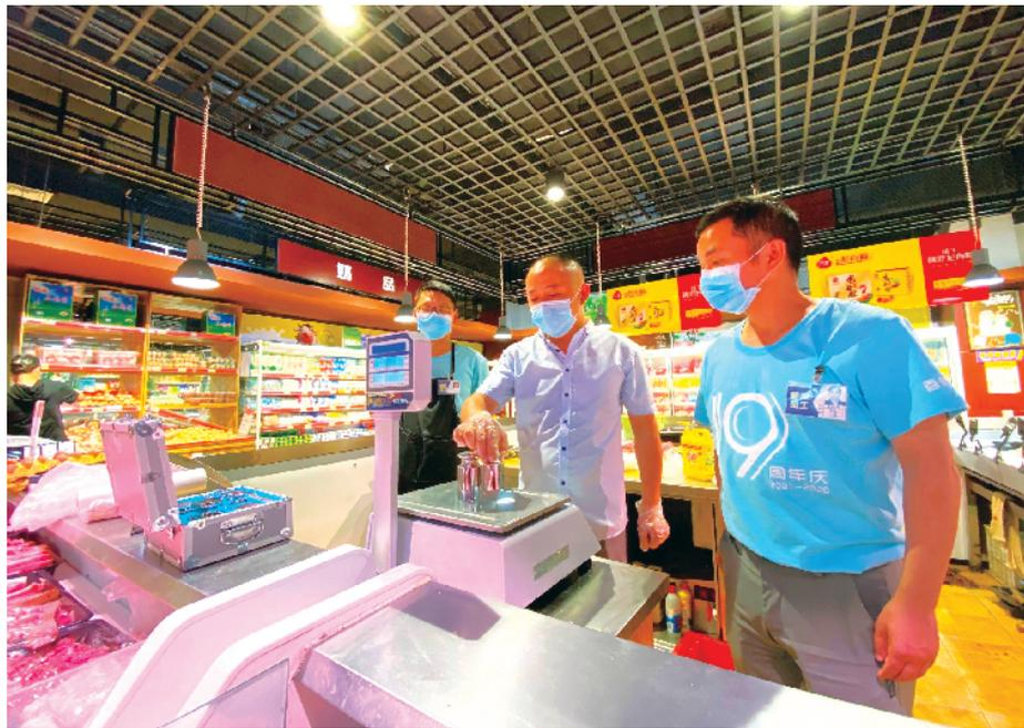
5月20日是第21个世界计量日,市市场监督管理局围绕“计量精准战‘疫’、助力复工复产”中国特别主题开展多种形式的计量宣传活动,并组织执法人员深入小区、市场、加油(气)站、超市开展民用“三表”及各种计量器具检测校准工作。图为市市场监管局计量工作人员正在对超市电子秤进行检测。
