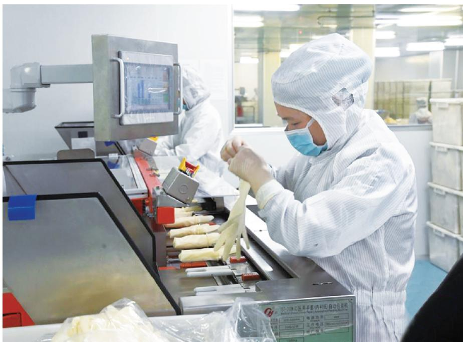
2月26日,在医用手套包装净化间,工作人员将检验合格的医用手套套在医用手套内衬纸包装机上。新冠肺炎疫情发生以来,位于北京市通州区的北京瑞京乳胶制品有限公司在做好防疫和安全工作前提下,加大医用手套的生产供应,为防疫一线提供物资保障。
