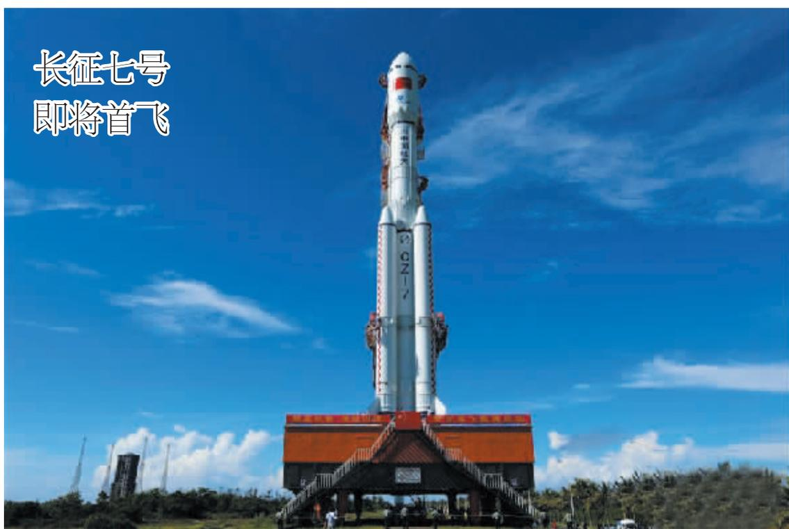
6月22日,承载着长征七号运载火箭与搭载载荷组合体的活动发射平台,从海南文昌航天发射场的垂直总装测试厂房驶出,平稳行驶约3小时后,安全转运至发射塔架。从中国载人航天工程办公室获悉,长征七号运载火箭计划6月25日至29日择机发射,执行首次飞行试验任务。
