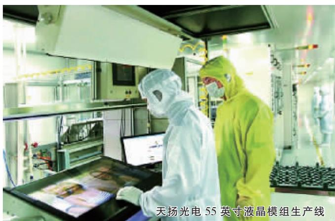
天扬光电 55英寸液晶模组生产线
