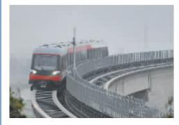
这是 12 月 22 日拍摄的在长沙上线调试中的磁浮列车。相比于传统的轨道交通和高速磁浮, 这条中低速磁浮列车采用环抱式设计,不仅实现了防脱轨的安全要求, 还具备噪声小、转弯半径小、爬坡能力强等优势。
