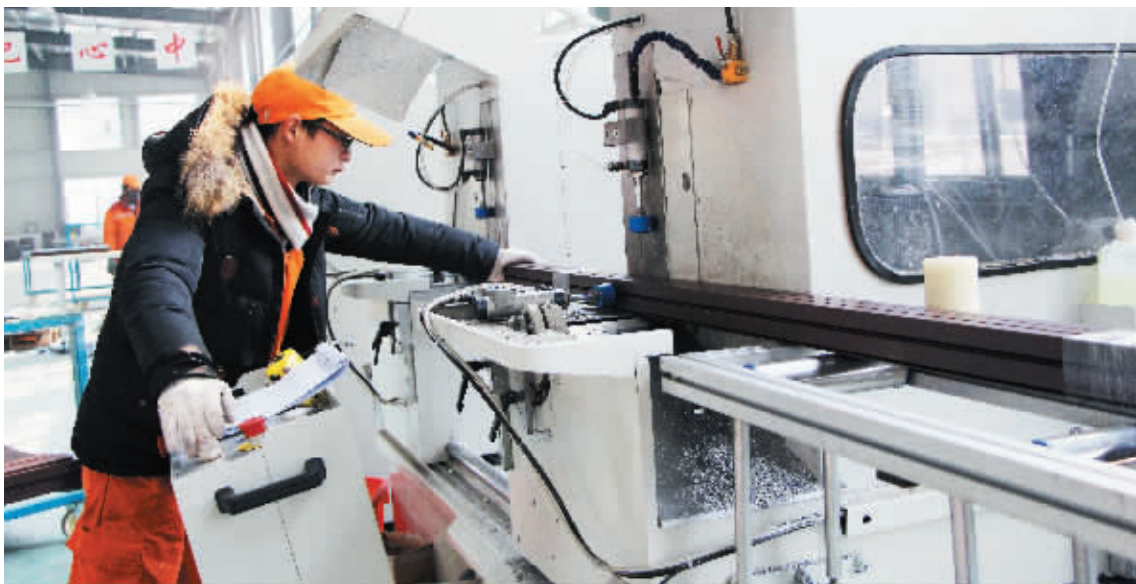
“天一美家家居文化创意产业园”项目位于信阳国际家居产业小镇北片区,占地面积约500亩,总建筑面积约40万平方米,总投资约12亿元。产业园由生产专业厂房、仓储配送、综合商务三大功能区组成,是信阳市推进工业化发展战略和打造中部地区现代化家居制造业基地的重点项目。项目于2014年6月正式开工,预计2015年5月全部完工。天一美家的门窗生产线已于2014年12月27日建成投产。图为天一美家的门窗生产线上,一名技术员正在操作铝门窗数控双头切割锯床切割铝材时的情景。 见习记者 张馨月 摄
