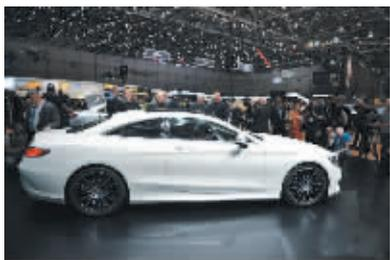
新款 S 级 Coupe 双门跑车与新款 S-Class 将会形成差异。汽油机系列将会包括作为基础动力的 4.7 升双涡轮增压发动机(S500/S550Coupe),最大功率 455 马力(335 千瓦),最大扭矩 700 牛·米。用于 S600Coupe 的则是全新 6.0 升 V12 双涡轮增压发动机,最大功率 530 马力(390 千瓦),最大扭矩 830 牛·米。柴油机向来不是 CL 级车型的选择,不过鉴于日趋严苛的排放标准,新款 S 级 Coupe 双门跑车可能会拥有一款由 3.0 升涡轮增压柴油发动机驱动的 S350CoupeBlueTec。当然,采用 5.5 升 V8 双涡轮增压发动机,最大功率 585 马力(436 千瓦),最大扭矩 900 牛·米以及采用 6.0
