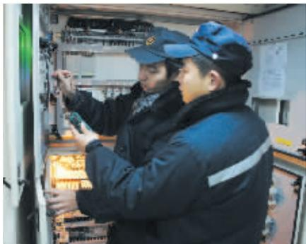
进入冬季以来,为防止空调客车电器设备绝缘不良,武昌客车辆段信阳运用车间针对控制柜内电器设备绝缘开展了有针对性的专项检查,消除了因线路破损、虚接、设备老化等原因造成的客车绝缘不良。图为1月1日,该车间技术人员正在测量电器绝缘情况。
