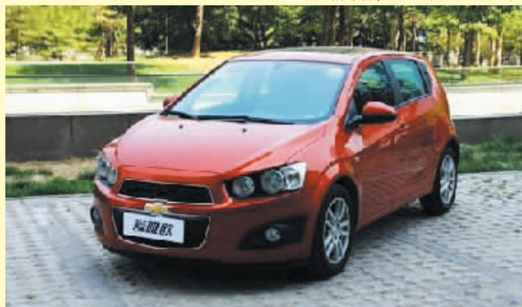
爱唯欧新颖的外形带有典型的雪佛兰家族特征,车身线条刚劲有力,给人很紧凑的感觉。无灯罩前大灯和 205 宽度的轮胎是比较吸引人的细节。长 4039 毫米,宽 1735 毫米,高 1517 毫米。三厢车型仅在车身长度上有所不同,车长 4399 毫米。这款车的轴距达到 2525 毫米,比 POLO、飞度和嘉年华等竞争对手都要大一些,甚至已经接近某些号称紧凑型轿车的车型,因此空间方面应该是一项优势。
