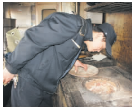
为了消除餐车安全隐患,提高炉灶热效率,武昌客车辆段信阳运用车间对普通客车餐车炉灶的炉体、炉膛、炉盘进行了一次专项检查,修复了炉灶故障和损坏的设备,确保了运用安全。图为11月21日,该车间的技术人员正在检查炉灶。
