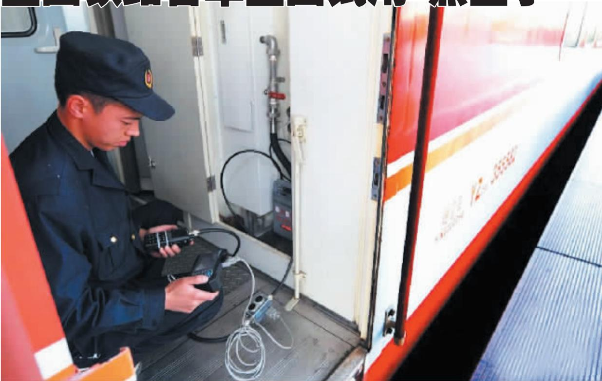
11月20日,南铁南昌车辆段一名技术人员正在K1187次九江至上海南的客车尾部车厢对客车“黑匣子”进行检测调试。当日,南昌铁路局开始在跨局直通旅客列车上试用俗称客车“黑匣子”的客车列尾装置。目前,中国铁路总公司在全路客车上全面试用该装置。列尾装置的全称是列车尾部安全防护装置,可以自动采集和传输客车尾部风压数据,为列车“把脉”,确保列车运行安全。(据新华社)
