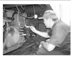
为了提高客车检修水平,武昌客车车辆段信阳运用车间从细节入手,强化检修工艺,提高作业标准,卡控检修过程,加强基础管理,确保了客车质量的稳步上升。图为10月13日,该车间的职工正在给螺栓涂打防松标记。 方妨 摄
