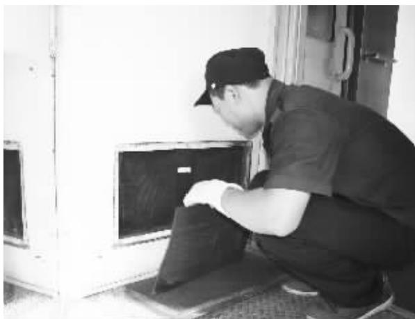
为了确保夏季餐车冰箱正常使用,武昌客车车辆段信阳运用车间开展冰箱滤网专项检查,对配属餐车滤网全部卸下清洗,并更换损坏滤网,确保了设备作用良好。图为该车间职工正在拆卸滤网盖板。方 昉 摄
