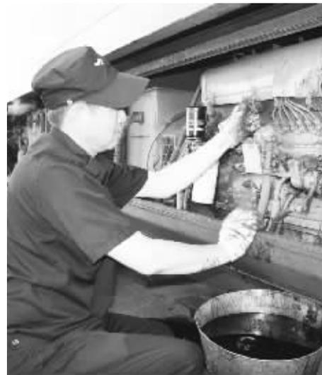
为确保客车防暑降温设备正常使用,武昌客车车辆段信阳运用车间对配属列车空调机组、柴油机组、发电机、电扇等防暑降温设备进行了专项检查,提高了设备运行稳定性,确保了旅客出行的舒适性。图为该车间职工正在检修单辆柴油机组。
