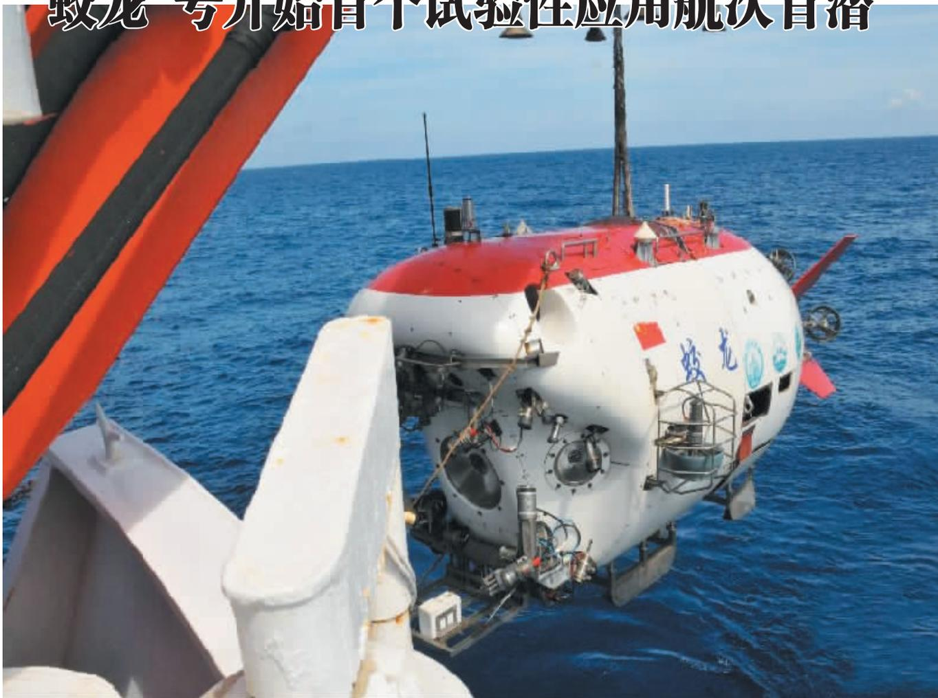
6月17日9时54分,“蛟龙”号载人潜水器被成功布放至南海冷泉作业区并开始下潜,执行首个试验性应用航次的首次下潜任务。这个潜次主要目的有三个:一是验证潜水器状态,二是进行潜水器长基线定位系统试验,三是锻炼潜航员在海山地形的驾驶技能。图为正在下降的“蛟龙”号载人潜水器(6月17日摄)。 新华社记者 张旭东 摄
