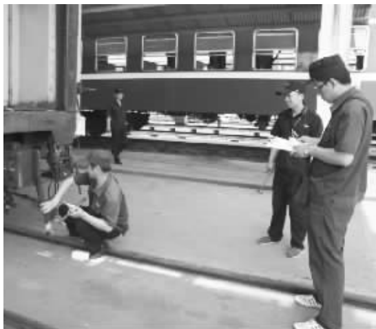
为进一步加强客车库内检修标准,武昌客车站车辆段信阳运用车间于近日组织开展了检车下部对规检查,组织干部、技术组对库检生产组检车作业过程、检修标准、作业质量进行了全程跟班,并对作业中存在的问题进行记录和分析,通过制定整改措施提高检修标准和水平。图为该车间正在对规检查。 方昉 摄
