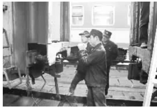
为提高客车车辆安全性和密封性能,武昌客车车辆段信阳运用车间将附属客车逐辆分离,对风挡进行全面检查,及时修复损坏部件,恢复设备性能。图为该车间职工正在更换风挡胶皮。 方昉 摄
