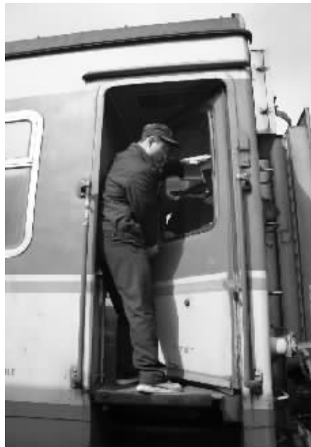
清明节期间,武昌客车车辆段信阳运用车间增开3趟临时旅游客车,为提高临客上部服务设施质量,该车间专门成立了上部质量整修小组,集中整修车辆门窗、座椅、厕所灯服务设施。图为该车间职工正在整修车门玻璃。
