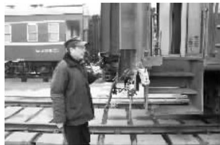
武昌客车站段信阳运用车间为了确保列车试风作业质量,建立了呼唤应答制度,在作业过程中,要求两人一组进行试验,待测试时间达到规定标准后平行作业逐辆巡视,确保试风效果。图为车间职工正在使用对讲系统发出指令。
