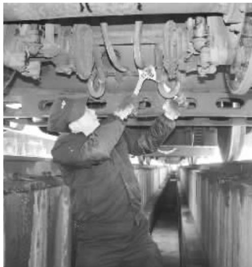
为确保春运期间列车制动系统良好,武昌客车车辆段信阳运用车间对列车下部空气制动、基础制动各部件、各管系进行全面检查,提高了春运客车的安全系数。图为这个车间职工正在紧固制动配件。
