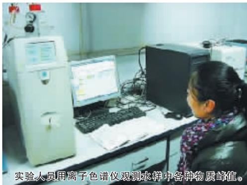
实验人员用离子色谱仪观测水样中各种物质峰值。
