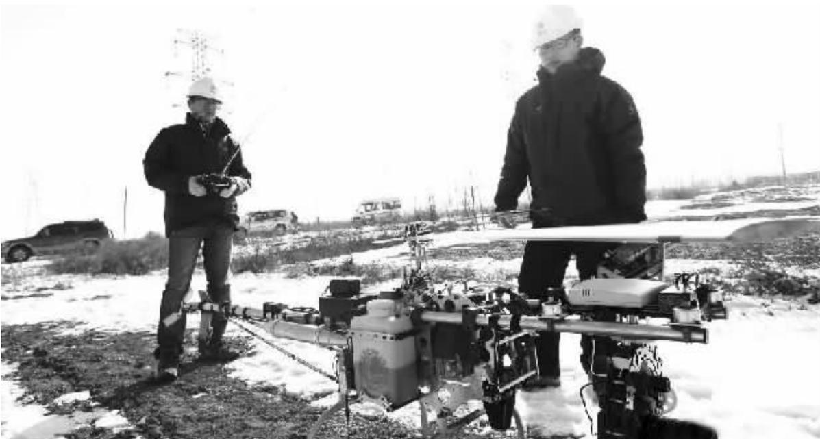
1月9日,工作人员操作无人直升机,准备对输电线路进行巡检。针对今冬山东持续低温、风大、能见度低的情况,国家电网山东电力集团在部分地区开展无人直升机智能巡检,充分利用无人机在空中的角度优势,全方位、高精度进行巡检,同时配合人工检查。国家电网山东电力科学研究院自主研发的“输电线路无人直升机智能巡检系统”,利用无人直升机作为载体,装载可见光照相机、可见光摄像机、红外热像仪及通信设备等对架空输电线路进行巡检。
