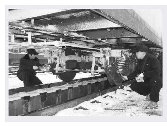
近日,为了提高列车质量,确保旅客出行安全,武昌客车车辆段信阳运用车间加强了列车制动装置、车体悬吊、绝缘等关键部位的卡控。图为该车间职工正在雪中作业。
