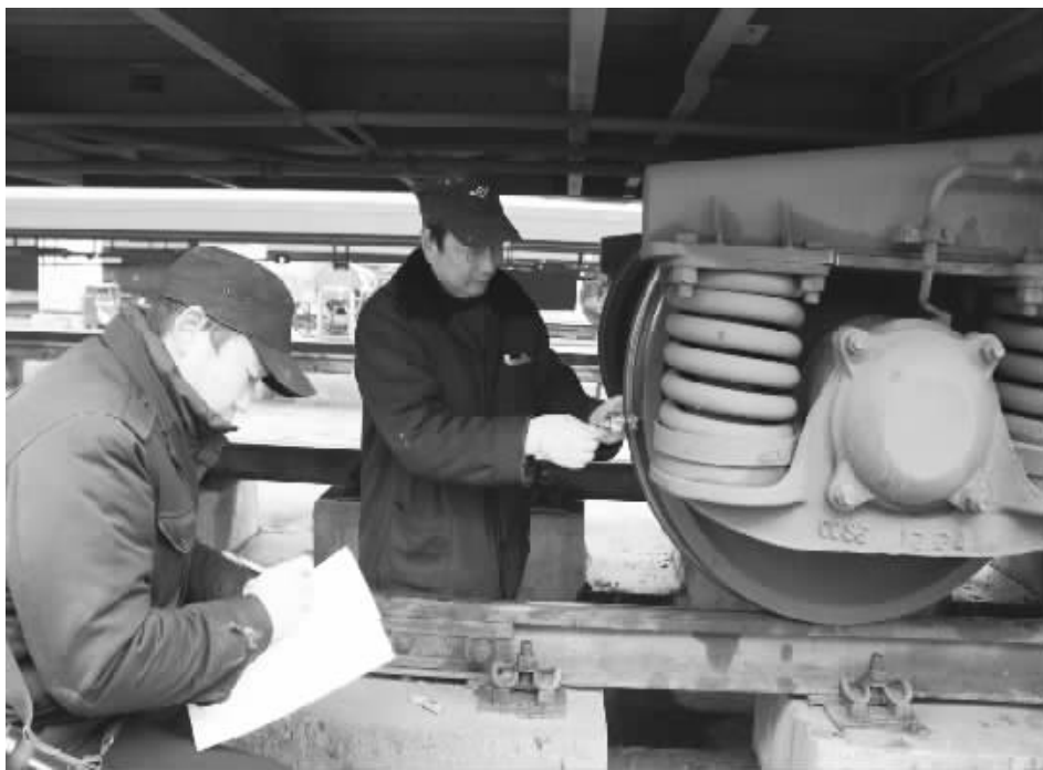
近日，武昌客车车辆段信阳运用车间全面开展春运列车大修工作，对配属客车走行部、制动装置、绝缘、车辆电器、发电车等进行全面整修。图为该车间职工正在测量列车轮对。 方昉 摄
