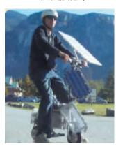
Terry Hope 最近很苦恼,因为 准型号的电动摩托车——不被允 许带上船,除非他可以把它塞进一 只行李箱,而且不使用船上的输电 网充电。于是他不得不做出了一些 小发明,那就是你从图上看到的这 种光/电混合动力脚踏车,它的电 池既可以使用电能充电,也可以使 用太阳能,而且,它还是可折叠的
