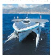
位于德国北部的 Knierim Yacht 造船厂日前造出了世界上 最大的太阳能小型船。这艘名为 Yacht 的小型船长 31 米, 宽 15 米,高7.5米,覆盖了500平方米 的太阳能发电板。这些发电板可以 发 103.4 千瓦的电,而只需要其中 的20千瓦就可以带动这艘船。虽 然设计时要求它达到的平均时速 是9英里,但最快时它可以达到 17 英里/小时。建造这艘船一共花费了1800万欧元,预计这个月内 这艘船将完成测试和水上航行。
